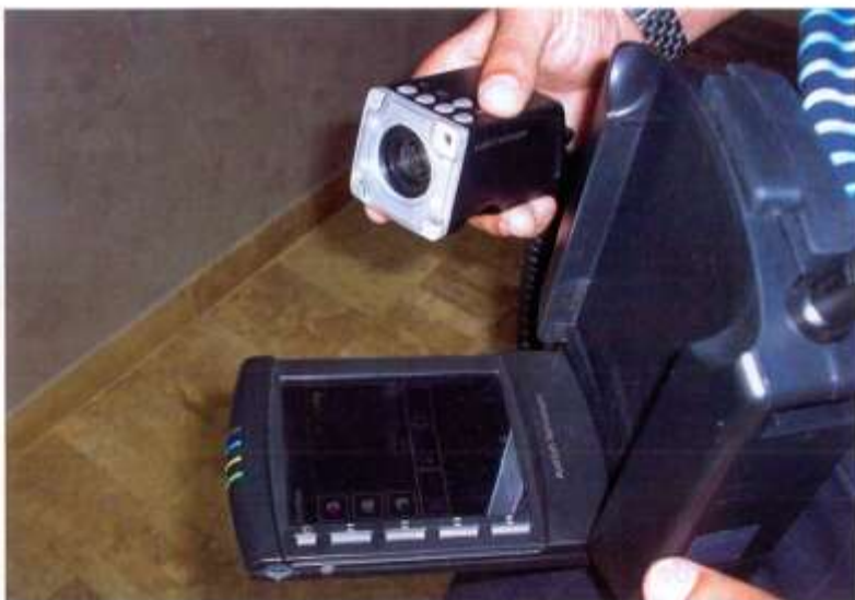
Caméra que la main peut balader en cas de chantier difficile et écran de contrôle.
